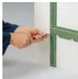
Připevnění stojin na zeď skrz otvory Ø 5 mm
